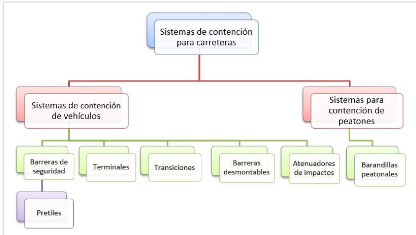
Figura 1: Tipos de Sistema de Contención
