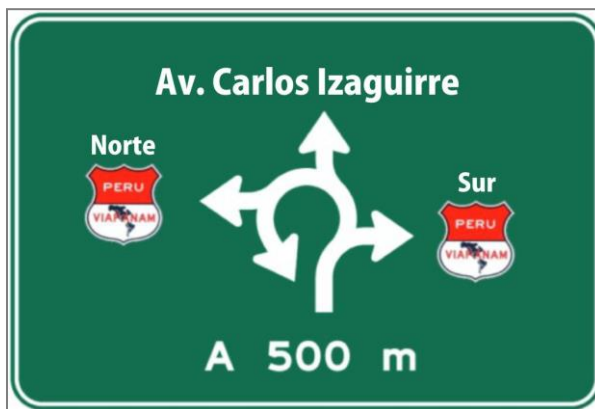
Figura 2.28 Ejemplo de diagramación para un óvalo
