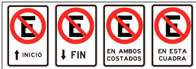
Figura 2.8 Ejemplos de Mensajes en Señal R-27
