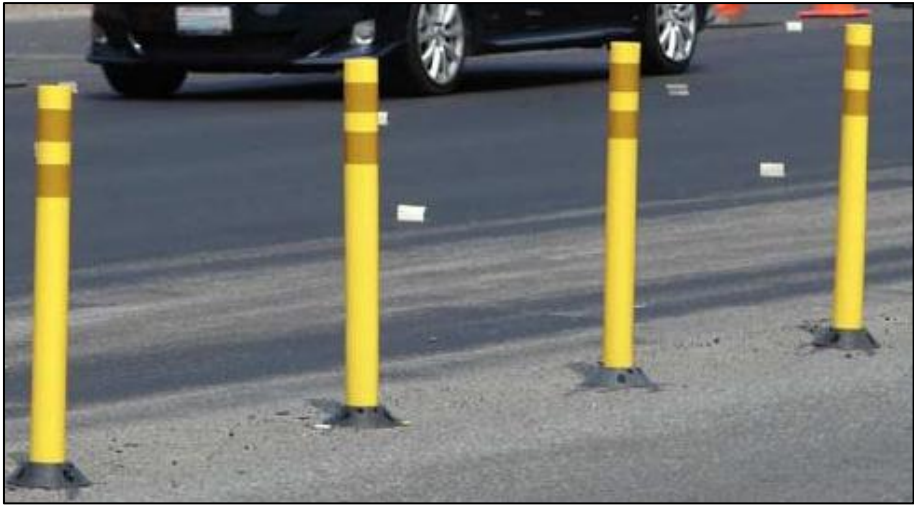
Figura 3.71 Ejemplo de delineadores “Tubulares Flexibles”
