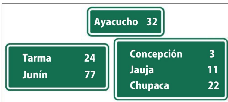
Figura 2.39 Ejemplos de señales de confirmación
