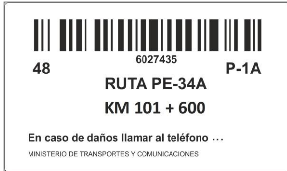
Figura 2.7 Ejemplo de Información parte posterior de la señal
