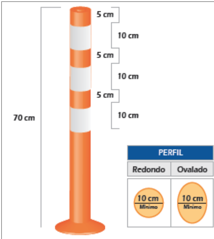
Figura 5.4 Ejemplo de un delineador simple con dimensiones.
