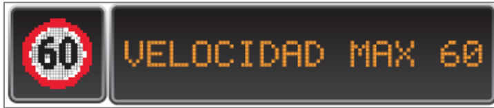
Figura 2.52 Ejemplo de una señal de una señal de mensaje variable luminoso de carácter informativo de una línea complementada con una señal reglamentaria de límite de velocidad como sistema inteligente de transporte
